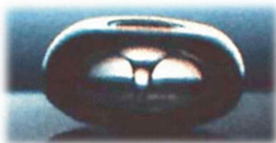
Рисунок 1 – Кавитационный пузырек в момент взрыва [1]
